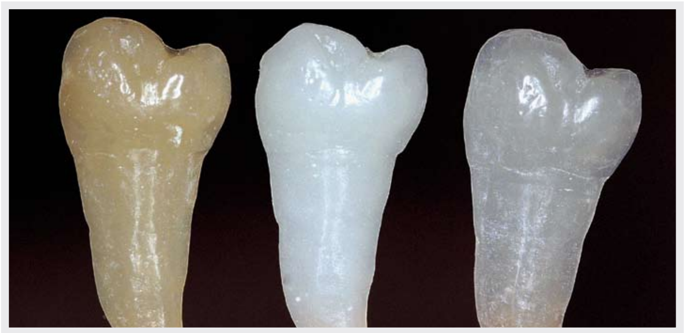
Figura 3 - Imagem de resinas para dentina, esmalte cromático e esmalte acromático sob luz refletida.
